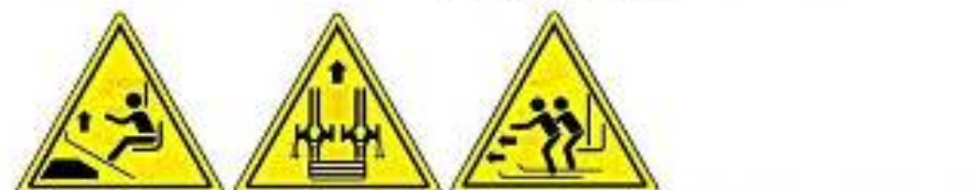
⑩ 降りる準備をせよ ⑪ 降りたら通過せよ(A) ⑫ 降りたら通過せよ(B) (⑩、⑪、⑫はリフト標識に使用される)
